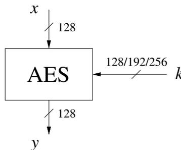
**Fig. 4.1** AES input/output parameters
